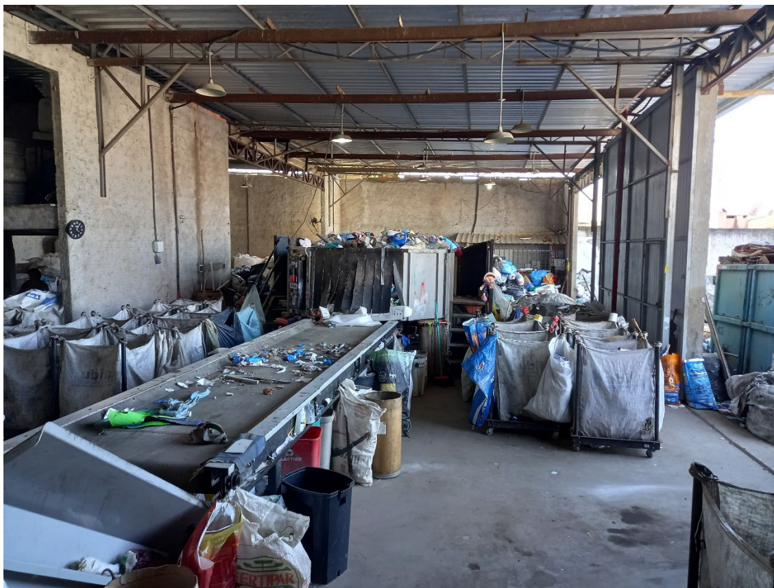
Figura 40 – Esteira de catação e big bags para armazenamento dos resíduos recicláveis
