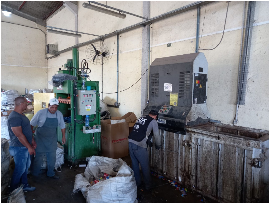
Figura 34 – Equipamentos utilizados na prensagem e enfiamento dos resíduos
