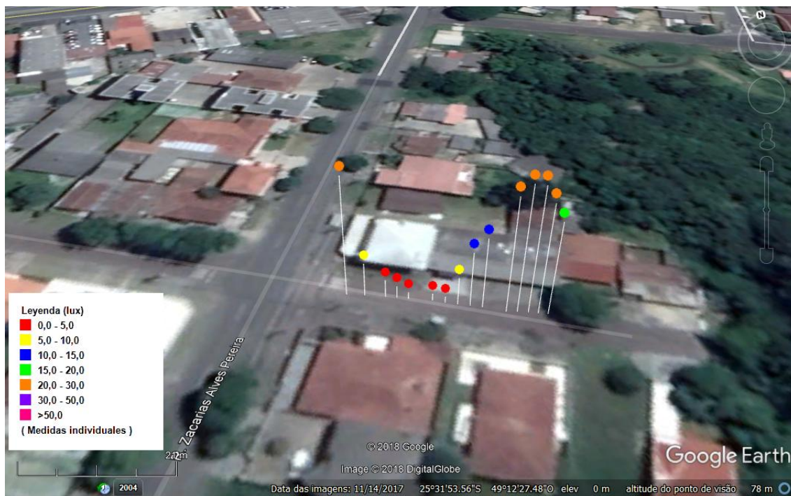
Figura 93: Imagem do Levantamento Luminotécnico – Rua Waldemar Zetola
