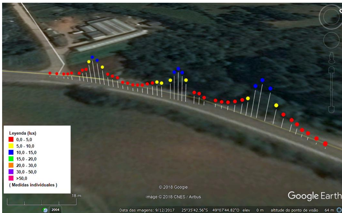
Figura 72: Imagem do Levantamento Luminotécnico – Rua João Lipinski
