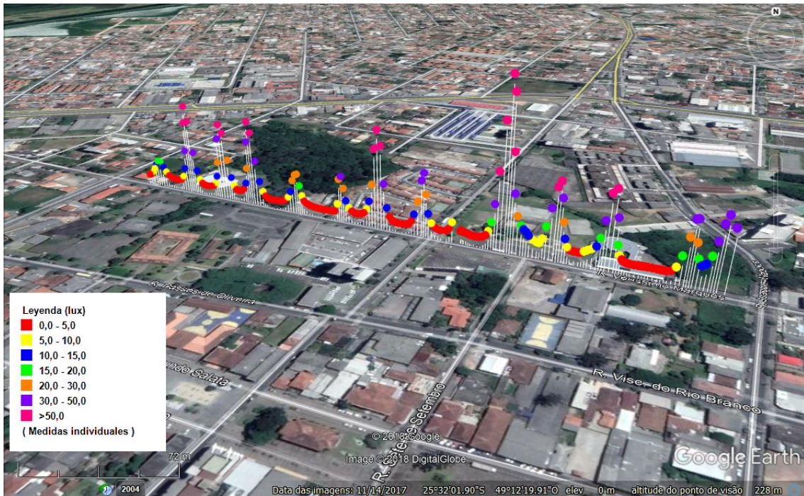
Figura 66: Imagem do Levantamento Luminotécnico – Rua Veríssimo Marques
