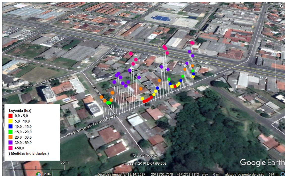
Figura 69: Imagem do Levantamento Luminotécnico – Rua Zacarias Alves Pereira
